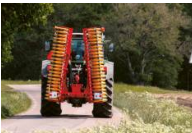
De transportbreedte van de Carrier X is slechts 2,4 m. Zelfs in ingeklapte toestand hebt u vanuit de cabine nog steeds goed zicht naar achteren.
