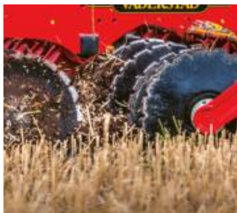
Twee rijen schijven van Zweeds kwaliteitsstaal werken tot op een diepte van 12 cm.
