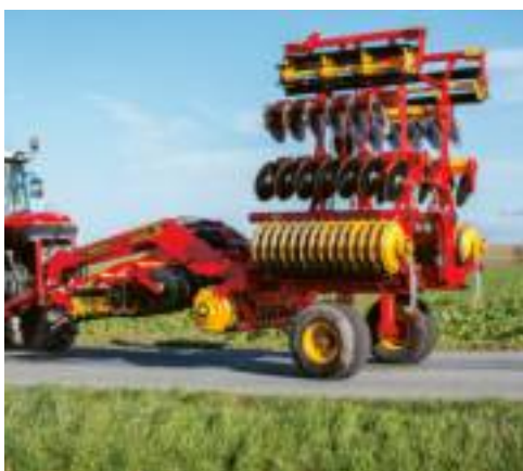
De Carrier 420-820 klapt in tot een transportbreedte van 2,5 m en kan dus gemakkelijk worden verplaatst.
