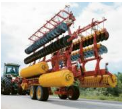
De Carrier 925-1225 is uitgerust met het unieke in- en uitklapsysteem van Väderstad. Ingeklapt is de transportbreedte 3 m.
