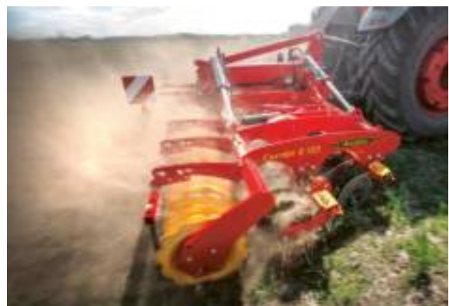
De werkdiepte wordt ingesteld vanuit de tractorcabine, voor aanpassing aan de veldomstandigheden.
