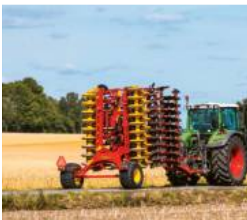
Bij transport van de Carrier XL 425-625 wordt de machine ingeklapt tot een breedte van 3 m.
